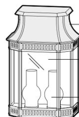
Assemblage en tôlerie soudée par points
